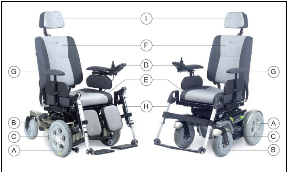
Figur 2.1: Forhjulstræk (FWD), baghjulstræk (RWD)
